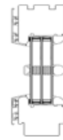
ALUMINIUMSPROSSE AUSSEN, S-SYSTEM HOLZSPROSSE UND S-SYSTEM GLASLEISTE INNEN, DUPLEXSPROSSE INNEN
