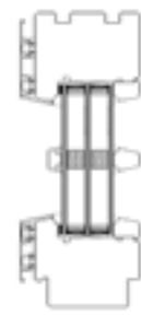
ALU-SPROSSE AUSSEN, HOLZSPROSSE TYP C INNEN, GLASLEISTE TYP C INNEN, VERGLASUNGSPAKET DUPLEX
